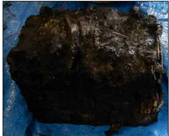
写真3 焼損バッテリー
