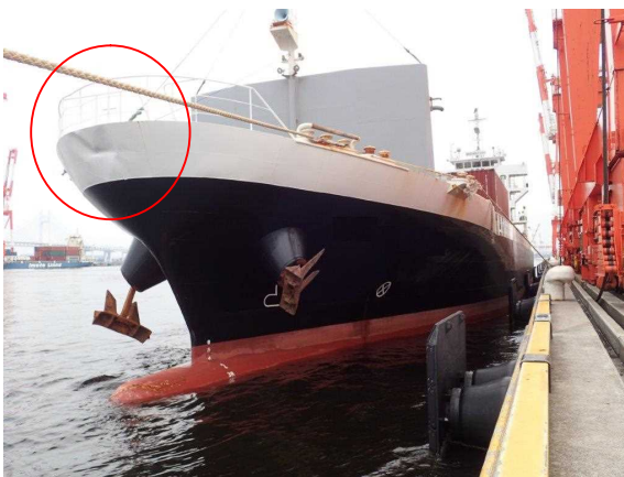
写真3 A船の損傷状況
