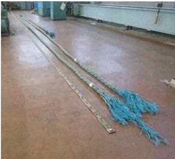
破断箇所に近い部分（全景）
