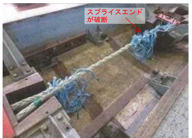
試料1の破断状況
