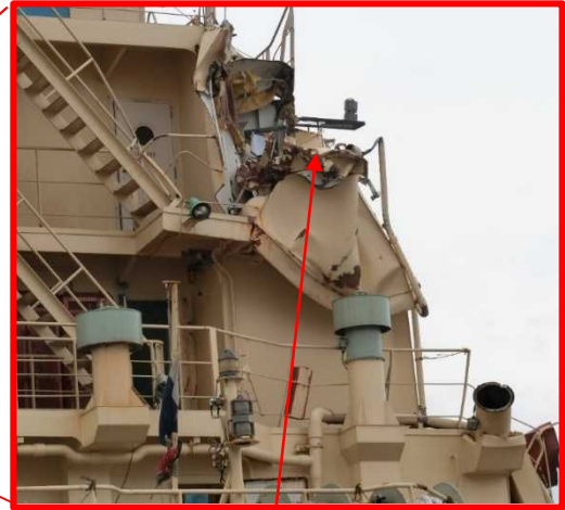
損失した右舷の救命艇クレードル 及び救命艇があった場所
