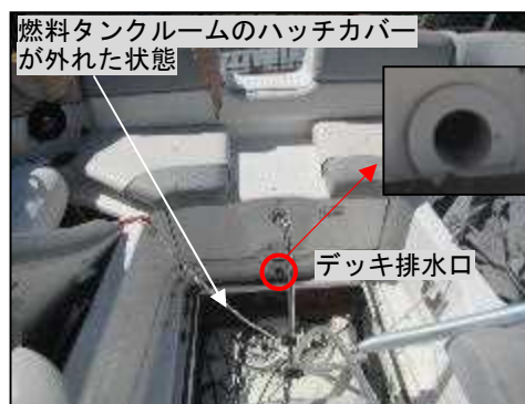
写真4 デッキ排水口
