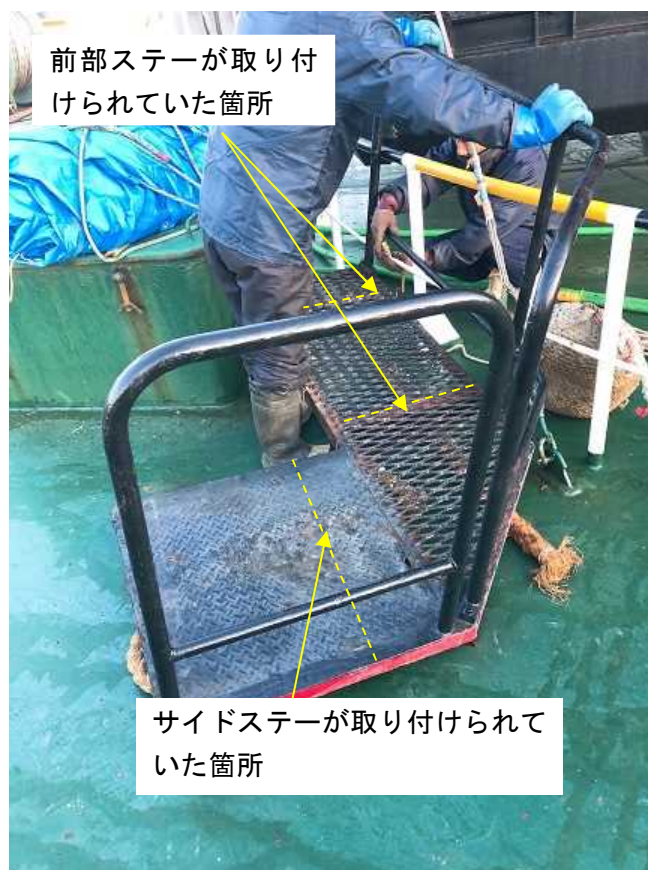
写真1 崩落した本件通路の状況
