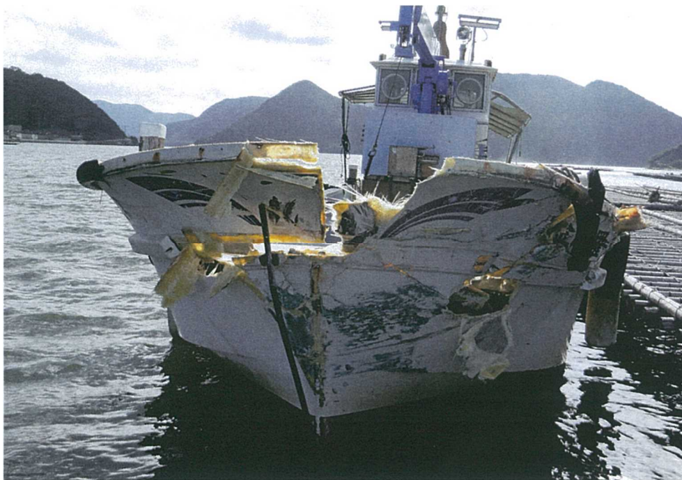
写真1 B船船首部の損傷状況
