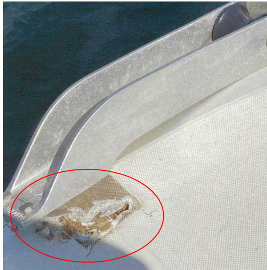
写真2 A船の損傷状況（アンカーガイドレール取付け部FRPの破損）
