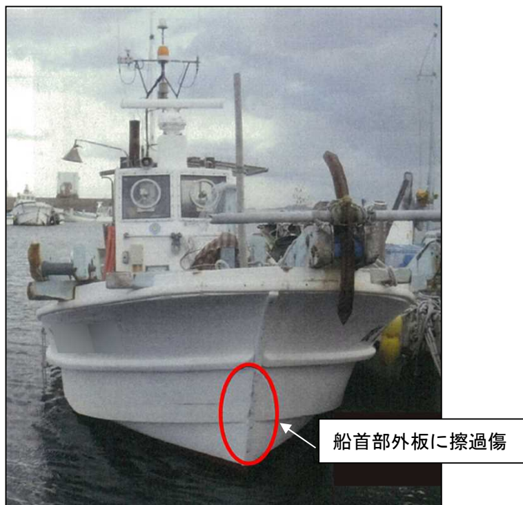
写真1 A船の損傷状況
