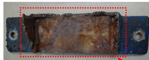
写真7 本件台座の支持部のプレート（分離した部分）
