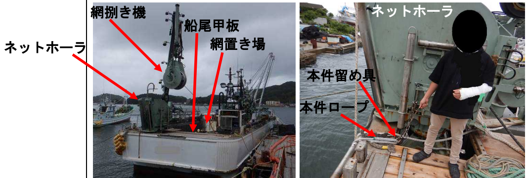
写真2 船尾甲板付近の状況 写真3 甲板員Aの作業状況(再現)
