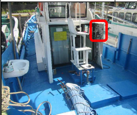
写真5 スイッチ及び主機遠隔操縦装置
