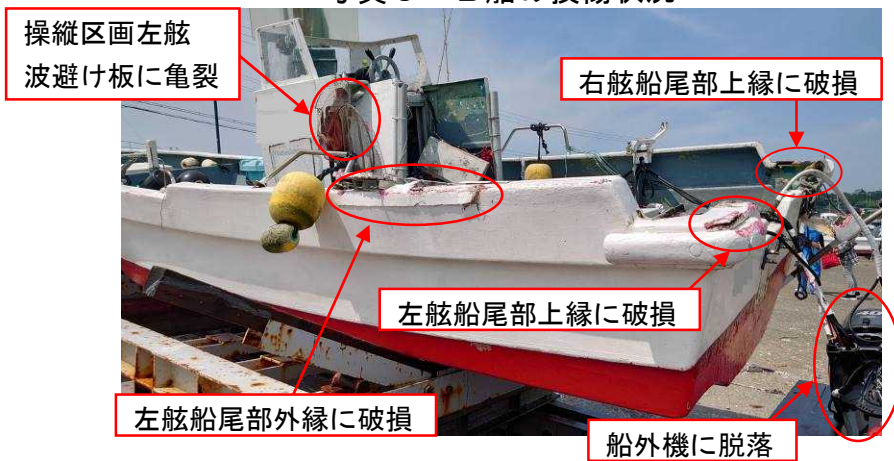
写真3 B船の損傷状況
