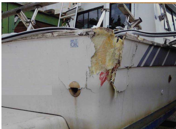
右舷船尾部に亀裂
