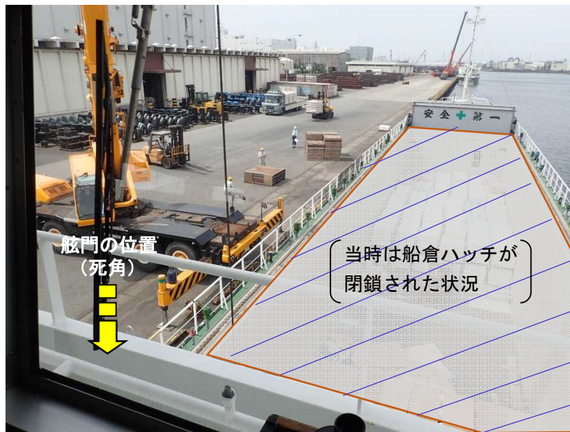
写真2 船橋（操船位置）から舷門の見え具合
