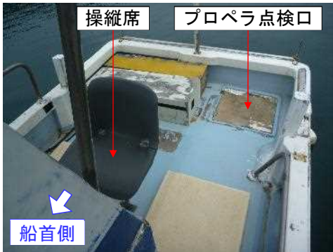
写真3 プロペラ点検口 (蓋を閉めた状態)
