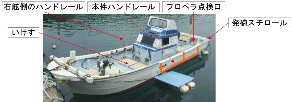
写真2 舷外に向かって倒れていた本件ハンドレールの状況 (イメージ)
