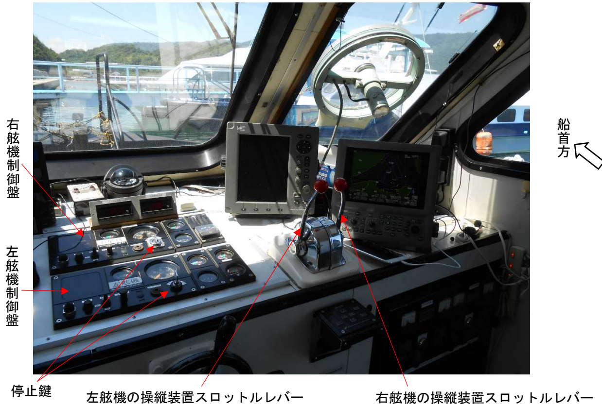
写真7 操舵室前面右舷側の状況
