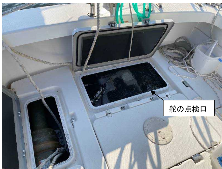
写真2 本船の舵の点検口（浸水状況）
