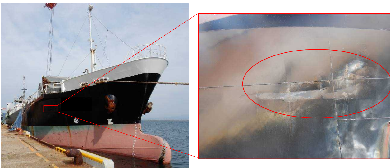
写真1 A船の損傷状況
