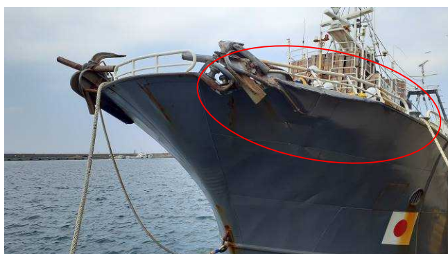
写真2 B船の損傷状況（1）
