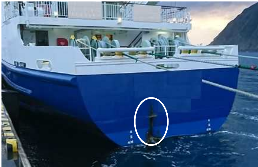
写真2 本船船尾部の損傷状況
