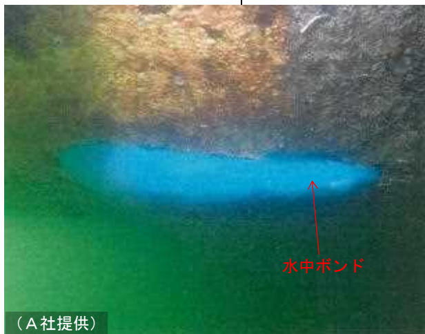
写真4 船尾部の船底中央の亀裂
