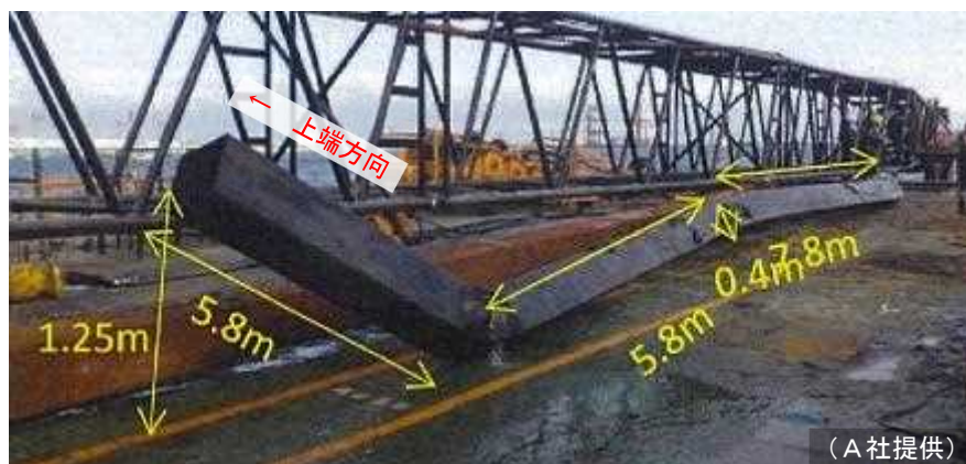
写真6 船尾スパッド（引揚げ時）
