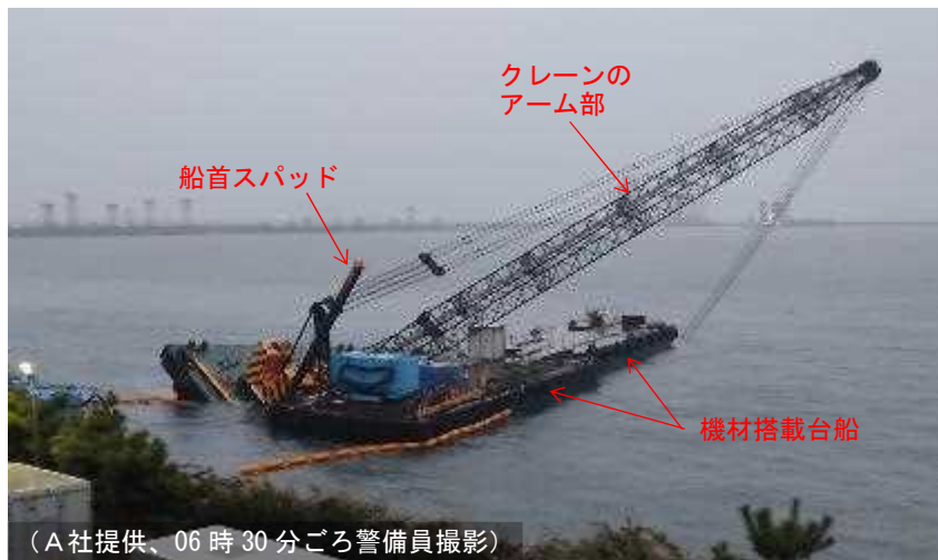
写真2 本船の傾斜の状況
