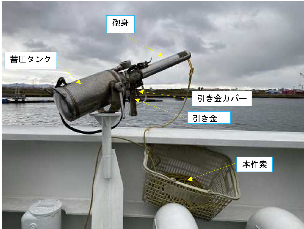
写真2 本事故発生時の本件発射器設置状況
