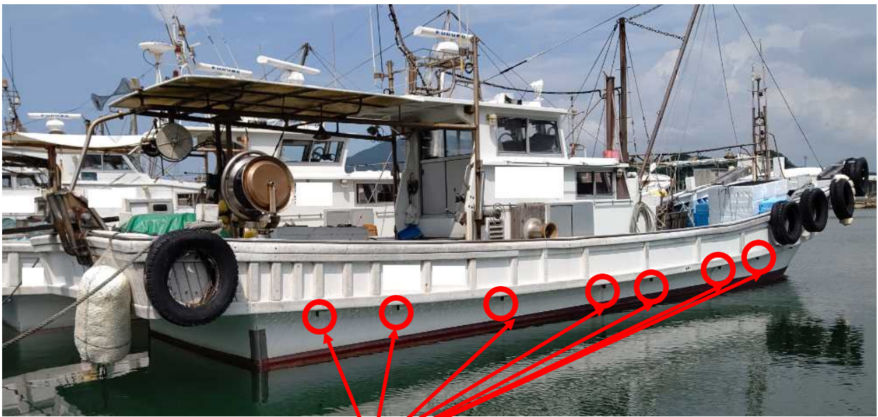
写真2 本船と同様の排水設備を備えた漁船
