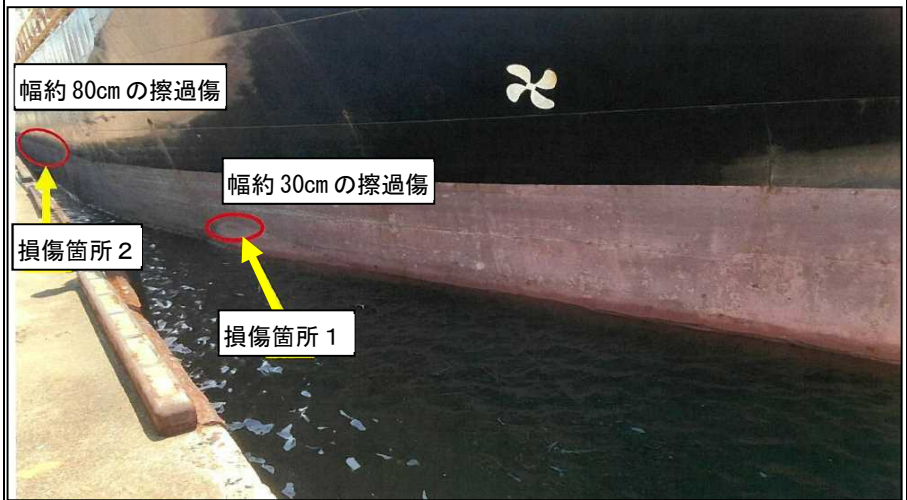
写真1 A船右舷船首部外板の擦過傷
