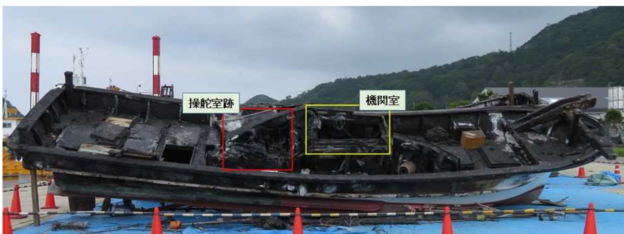
写真4 A船の焼損状況（上甲板）
