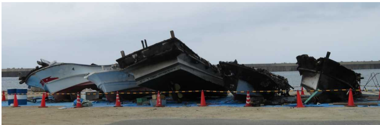
写真4 A船の焼損状況（上甲板）
