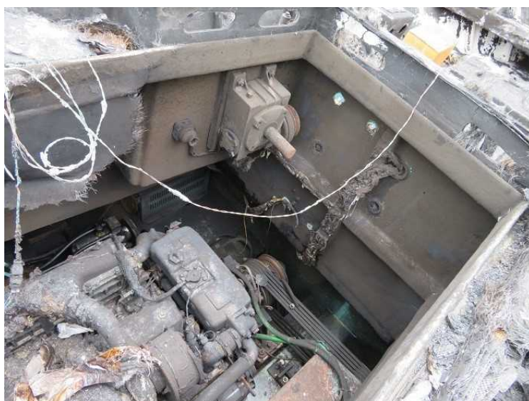
写真6 A船の焼損状況（機関室）
