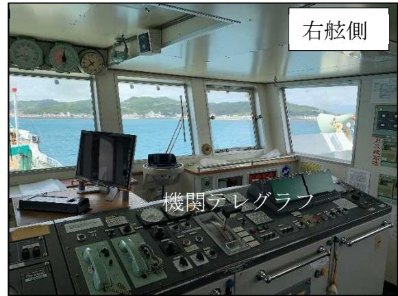
写真14 機関テレグラフ
