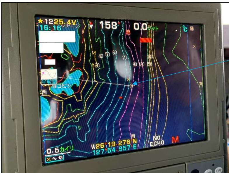
写真4 B船操縦室内にあるGPSプロッター画面
