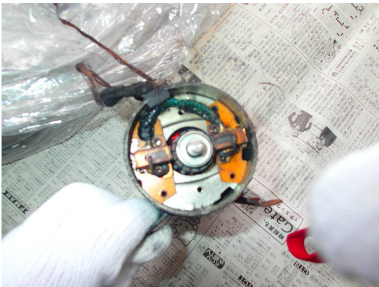
写真4 電動ビルジポンプ用モータ内部の状況
