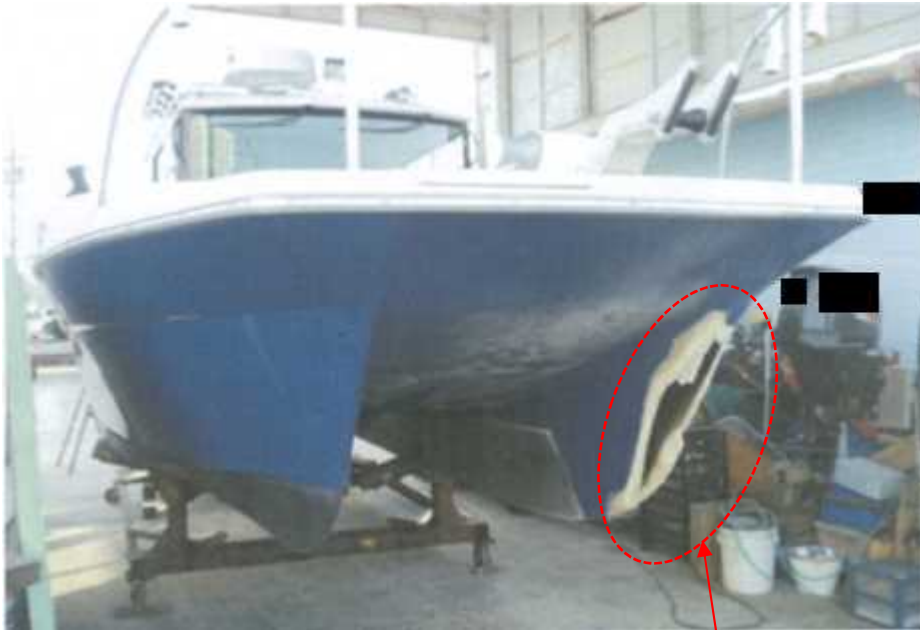
破口部（修理中）
