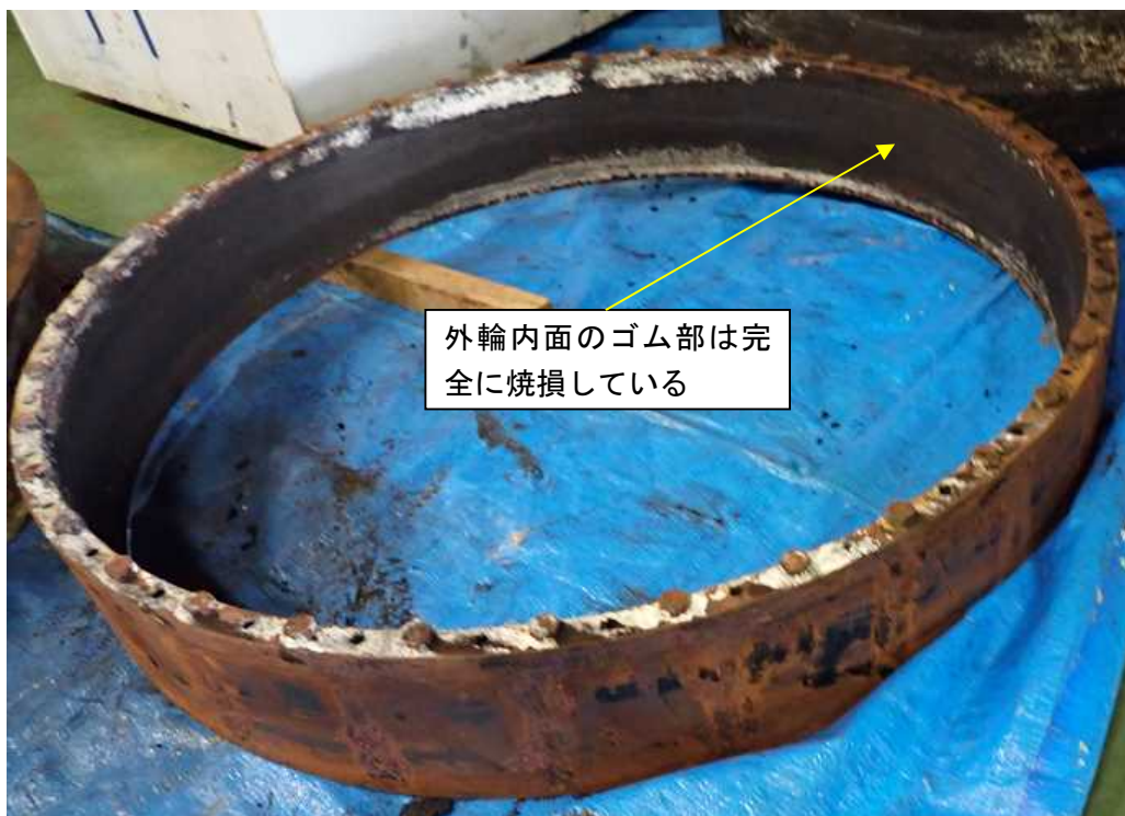
写真2 本件弾性継手の外輪の状況
