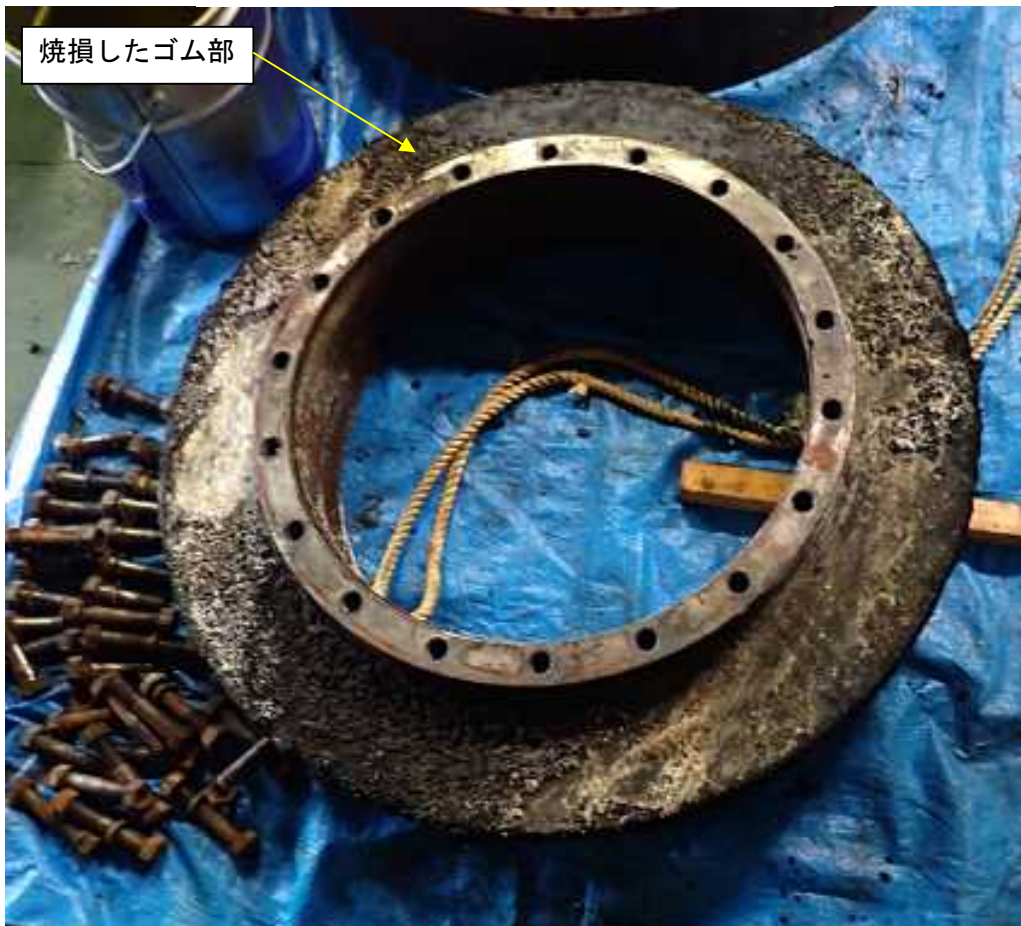
写真1 焼損した本件弾性継手の状況
