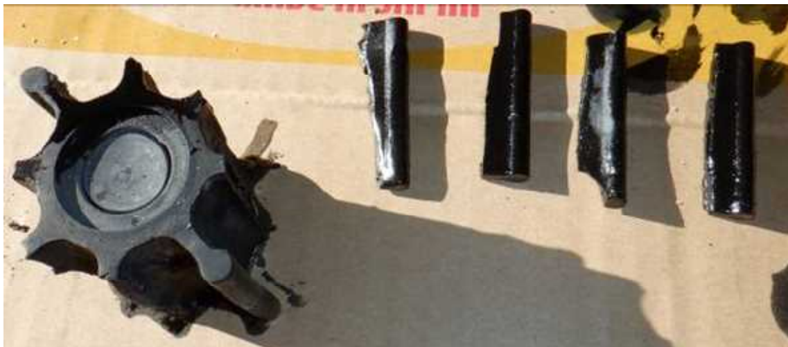
写真1 インペラ破損状況
