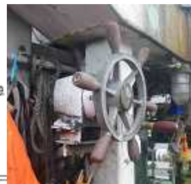
写真1 同型船の仕切弁開閉ハンドル
