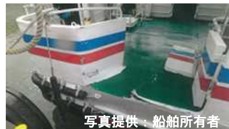
写真2 右舷船尾部乗降口舷側外板の破損
