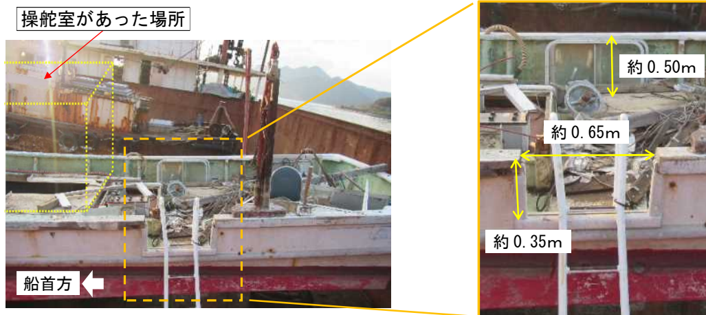
写真3 後部甲板のブルワークの高さ及び左舷側開口部の寸法（解撤作業中の本船を撮影）
