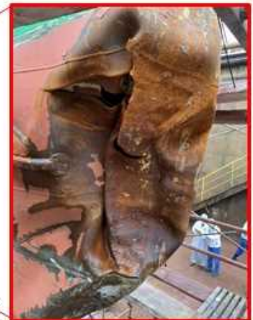
(球状船首部外板の破損状況)
