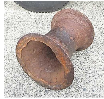
写真7 本件ドラムの破断分離部
