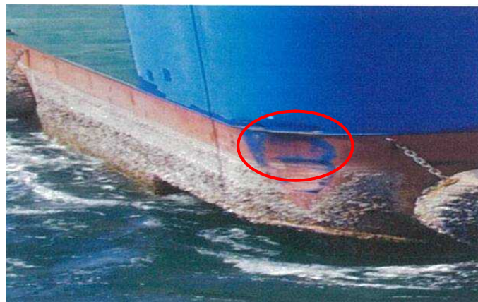
写真5 C船の損傷状況
