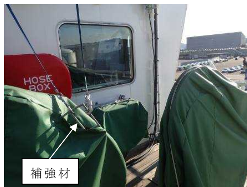
写真7 墜落制止用器具のフックを掛ける補強材
