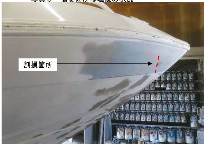
写真3 損傷箇所修理後の状況
