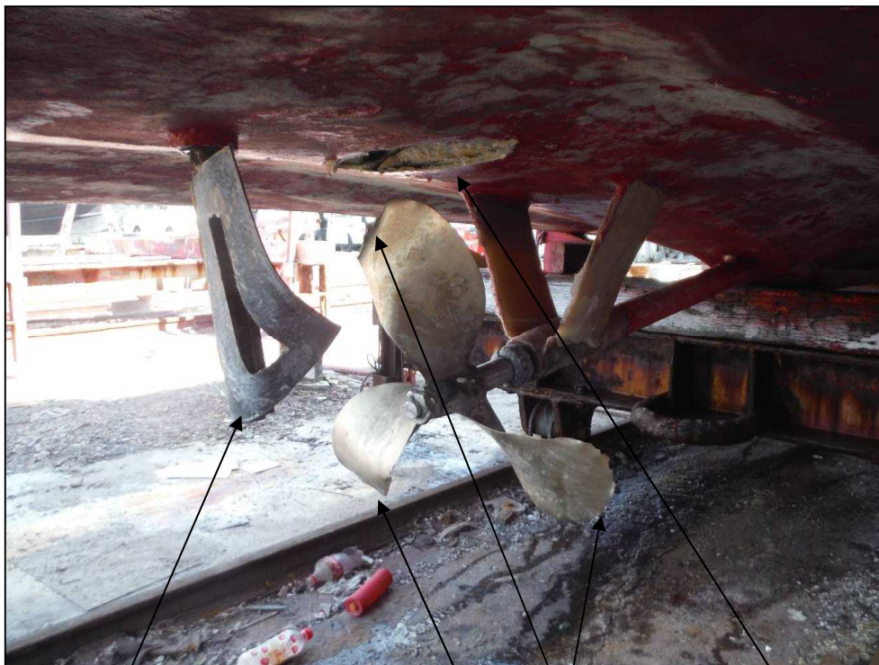
写真2 プロペラ翼等損傷状況
