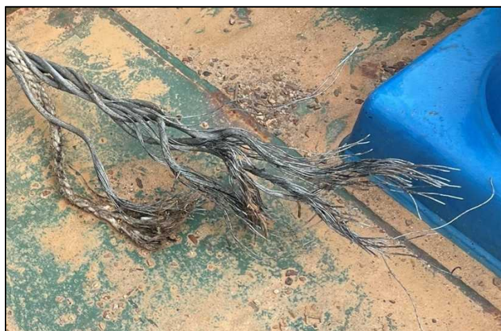
写真6 右舷船首部ワイヤロープ破断
