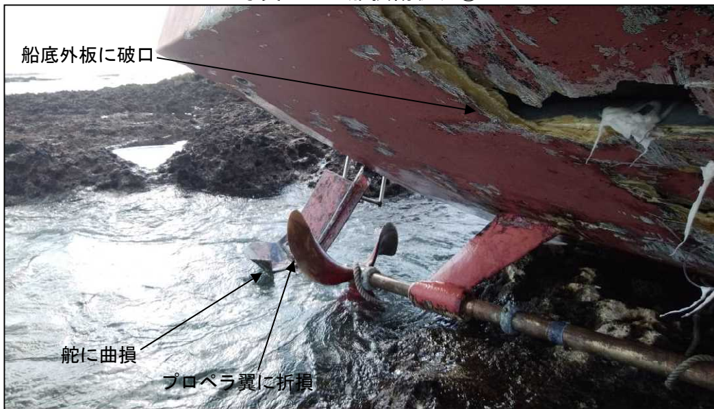
写真2 A船損傷状況①
