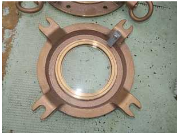
写真3 新しいプロペラ点検窓
