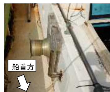
写真7 右舷側ドラムの取付状況
