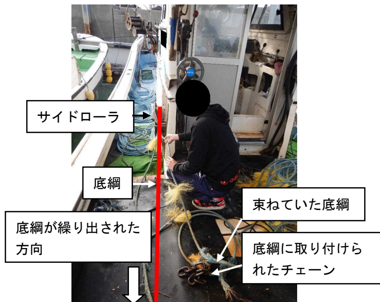
写真4 後部ローラに掛ける底網を束ねる作業
