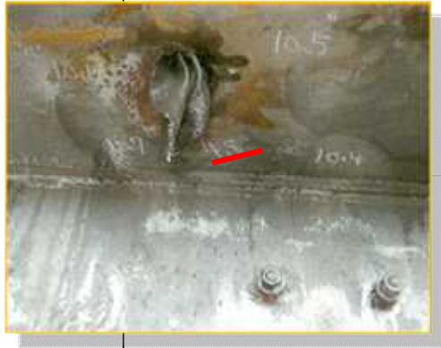
写真2 破口付近の板厚計測
