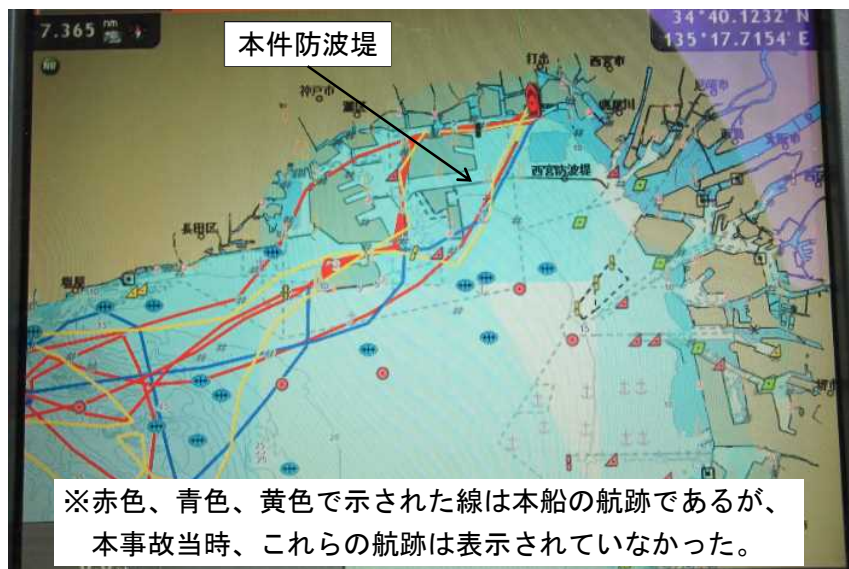
写真3 本事故当時の本件航海計器の表示画面の再現
