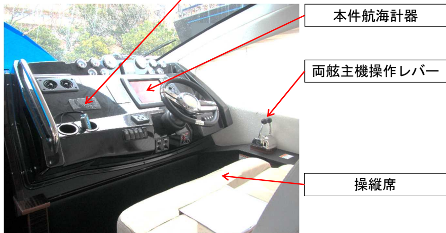
写真1 操縦盤及び操縦席
