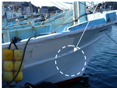
損傷箇所（擦過傷）
