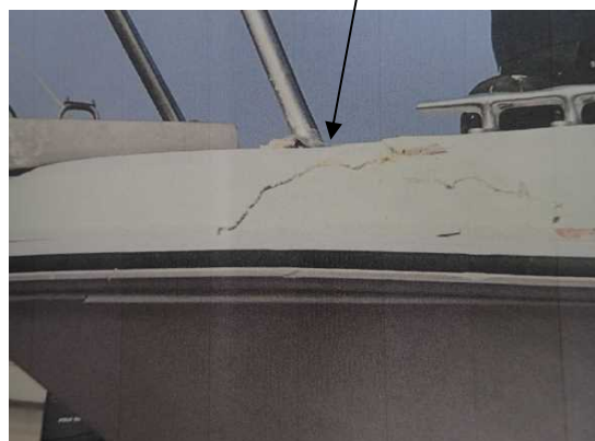
損傷箇所（亀裂）
