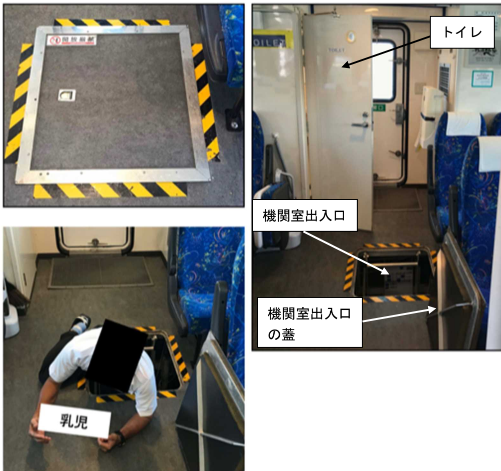
写真2 機関室出入口及び事故発生状況（再現）
