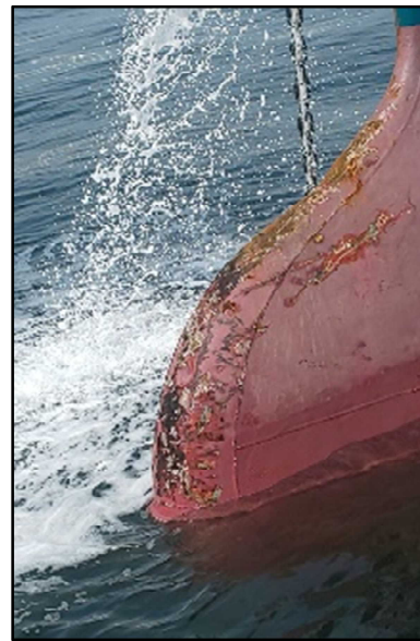
写真2 B船の損傷状況
