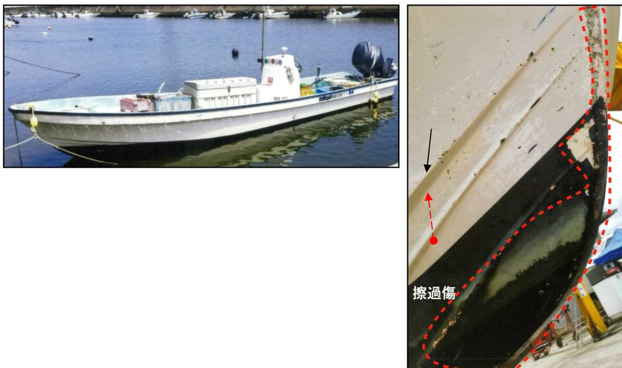
写真1 A船及びA船の損傷状況
